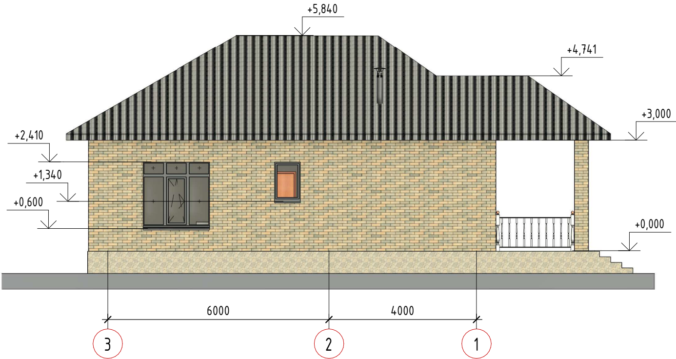
Фасад в осях 4-1
